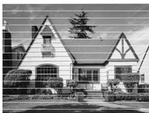
当打印头喷嘴阻塞时，打印样页将如上图所示。
