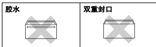
信封厚度，尺寸和封口形状有时候将会导致进纸问题。
